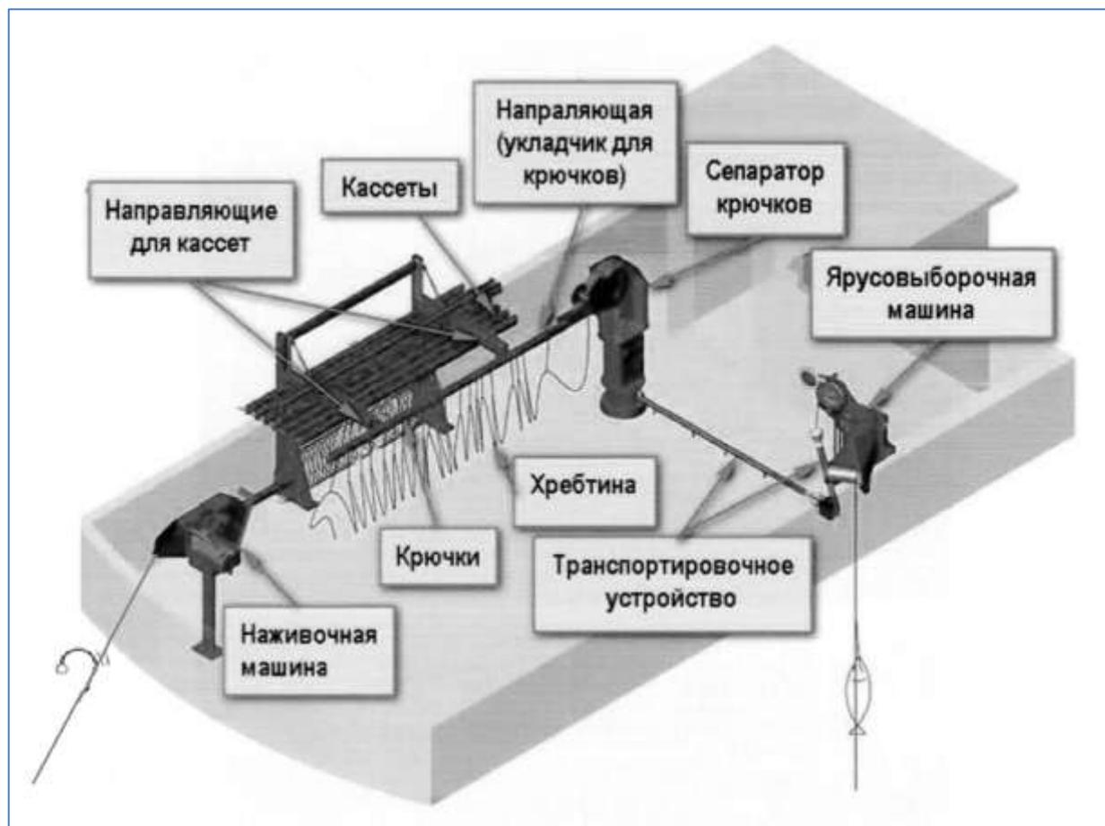
Рисунок 137 – Расположение на судне элементов механизированной линии ярусного лова (вид с кормы и правого борта)
