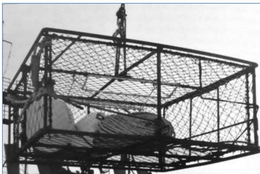
Рисунок 107 – Ловушка крабовая прямоугольная каркасная
